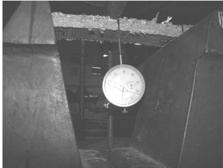
Imagen 10 Probeta lista a ser ensayada por flexión.
