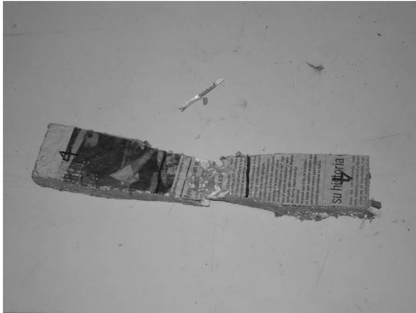
Imagen 12 Probeta ensayada por tracción.
