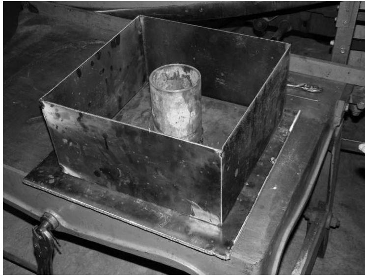
Imagen 7 Dispositivo o molde utilizado para realizar los tableros.
