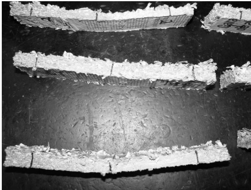
Imagen 11 Probetas ensayadas por flexión
