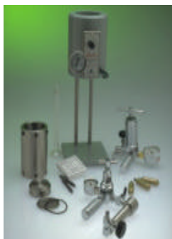
Figura 2.6.- Filtro Prensa de 175 ml (APAT).
