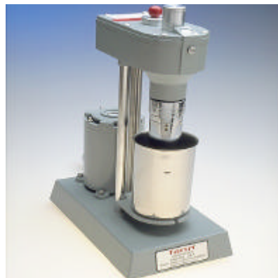
Figura 2.4.- Viscosímetro Rotacional Modelo Fann 35 A.
