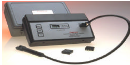
Figura 2.17.- Equipo Medidor de Estabilidad Eléctrica Modelo Fann 23D.
