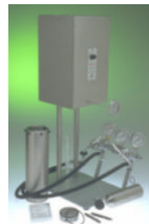
Figura 2.7.- Filtro Prensa de 500 ml (APAT).
