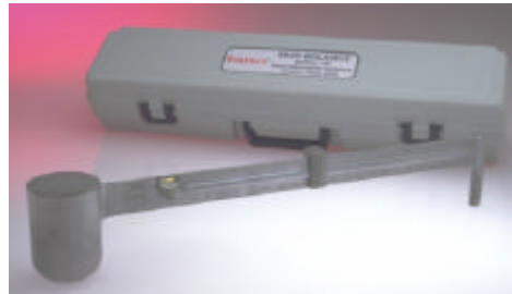
Figura 2.12. Balanza para lodo Modelo Fann 140.
