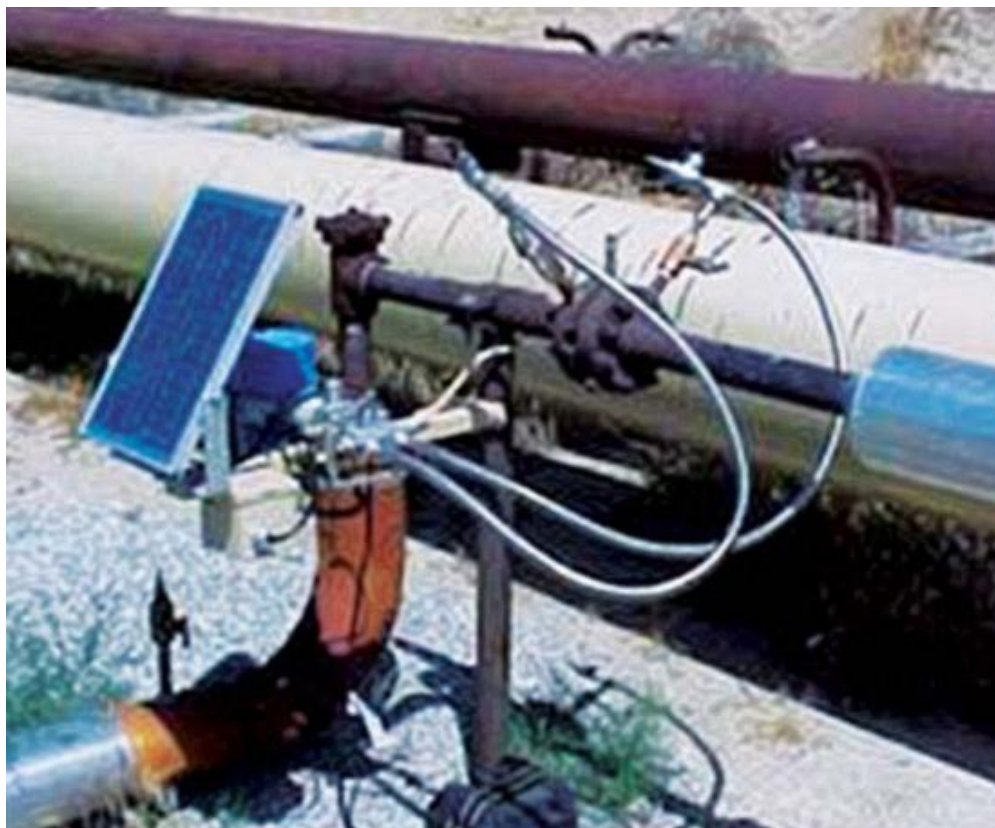
Figura 3.11. Equipo de medición de Calidad de Vapor desarrollado por la compañía Chevron para sus operaciones de inyección de vapor (Hanzlik, 2009).
