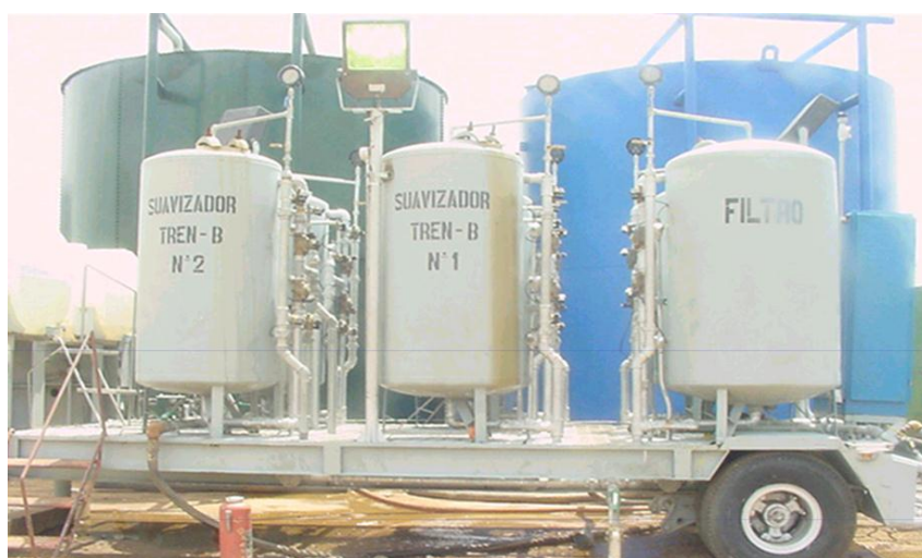
Figura 3.53. Unidad de Tratamiento de Agua Portátil (PDVSA, 2004).
