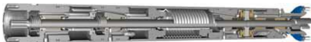
Figura 3.38. Protector de Motor Avanzado con opción de fuelle metálico (Schlumberger, 2007).
