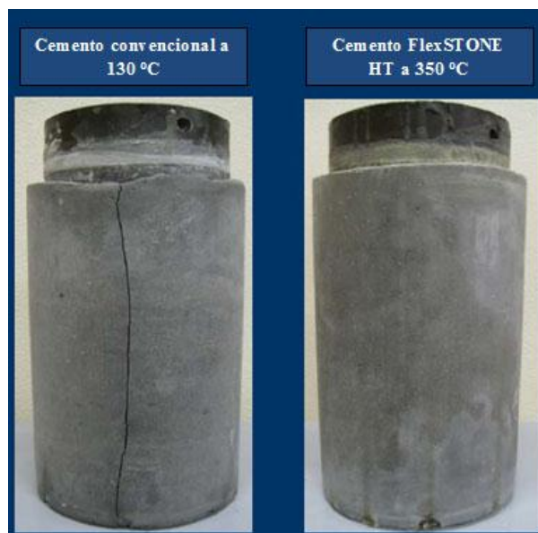
Figura 3.34. Comparación de la Resistencia a la Alta Temperatura entre el Cemento Convencional y el Flexstone (Bashbush, 2008).
