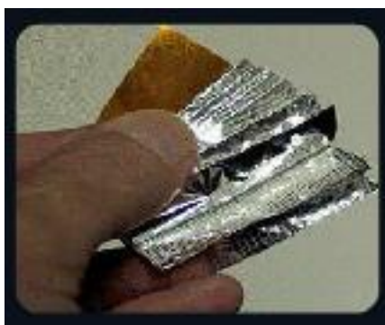
Figura 3.45. Combinación Papel de aluminio y Lana de Vidrio que se Utiliza en las Tuberías con Aislamiento Térmico de Alto Vacío (NorthPoint Systems, s.f.).
