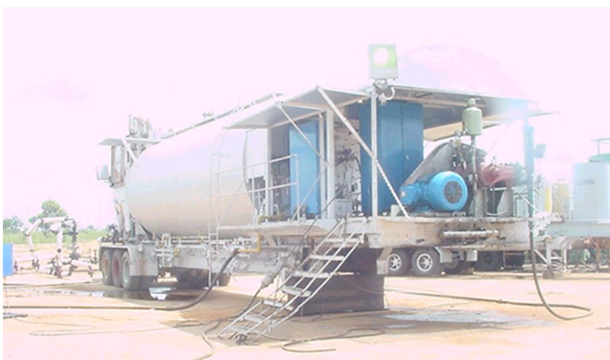
Figura 3.52. Generador de Vapor Portátil (PDVSA, 2004).
