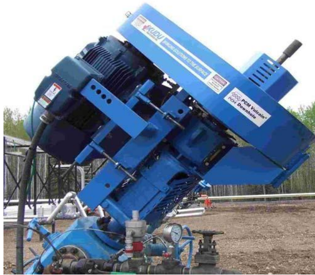
Figura 3.41. Unidad de cabezal de pozo con BCP Metálica (Beauquin y Ndinemenu, 2007).
