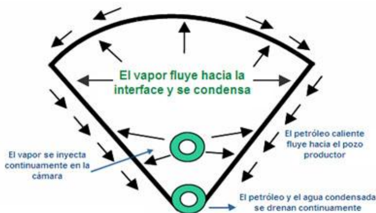
Figura 3.18. Sección vertical del método SAGD. Movilización de los fluidos en el sistema (Lechiguero, 2010).
