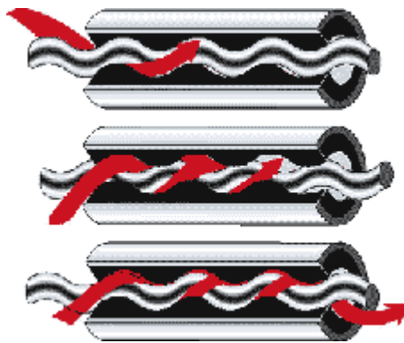
Fig. 31 Principio de operación de una BCP.
