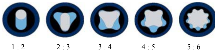
Fig. 38 Cortes transversales de BCP de simple lóbulo y multilobulares.
