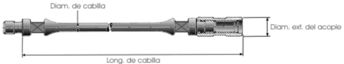
Fig. 44 Cabilla con acople según las normas API
