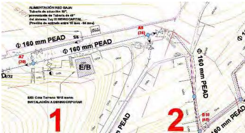
Figura 5-11: Configuración de la Red de Distribución propuesta para el Barrio La Palomera.
