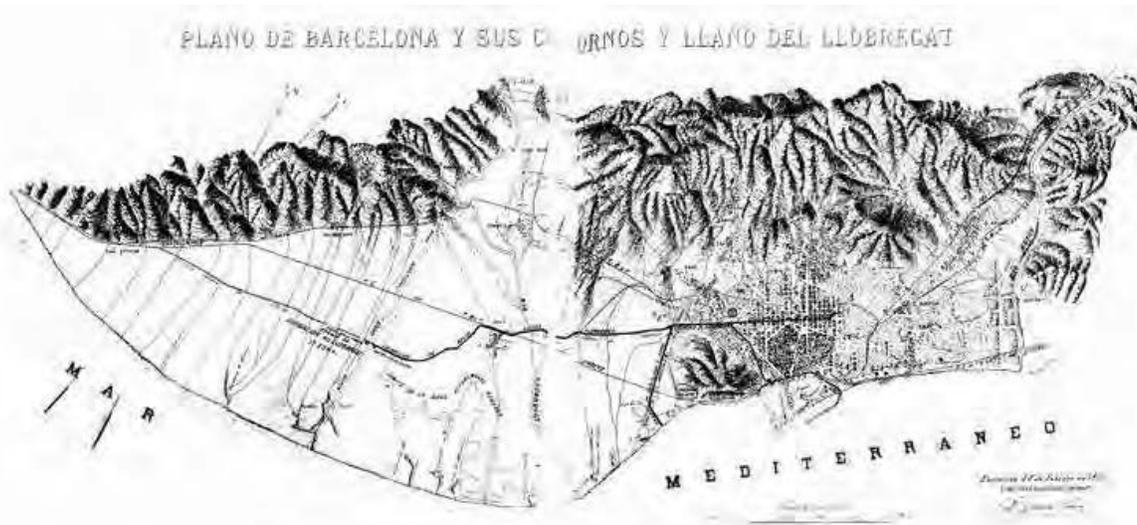
**Figura 3-25:** Plano de Barcelona y Emisario hacia el Llano de Llobregat. El plano de conjunto preparado por Pedro García Faría en 1891 indica su propuesta de construir un colector emisario hacia el oeste de Barcelona, para irrigar las llanuras del río Llobregat. Además, se aprecia la propuesta de rectificar el cauce de este río, lo que permitiría el mejor aprovechamiento de las tierras adyacentes a la ciudad.
