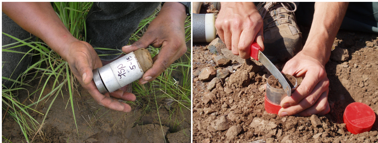
Figura 3. Toma de muestras no alteradas mediante el uso de cilindros.
