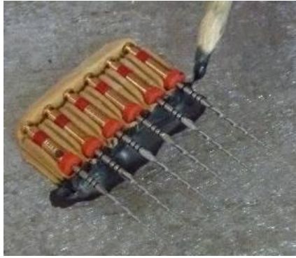
Figura 28. Registro fotográfico de las muestras sobre el dispositivo de silicona elaborado y el momento en el cual se le colocaba la pintura de grafito (Colloidal Graphitie/Ladd Research Industries)
