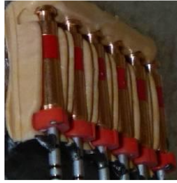
Figura 28. Registro fotográfico de las muestras sobre el dispositivo de silicona elaborado y el momento en el cual se le colocaba la pintura de grafito (Colloidal Graphitie/Ladd Research Industries)
