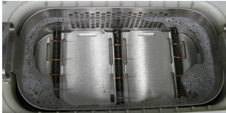
Figura 31. Registro fotográfico de la batea ultrasónica donde fueron colocados los instrumentos una vez lavados con agua corriente y jabón.
