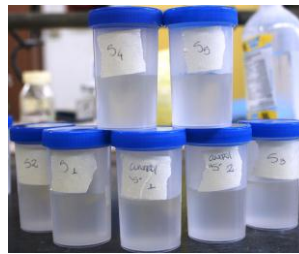
Figura 2: Grupo "G": Ensayo preparado con \text{Ca(OH)}_2 y glicerina
