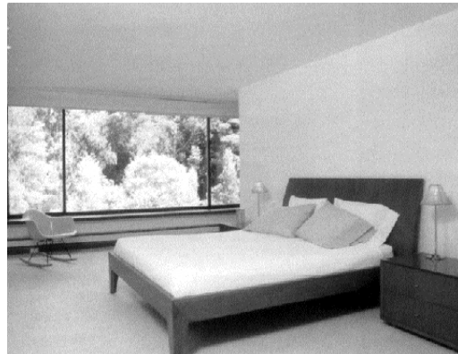
Figura 109 Utilización de colores claros en cerramientos interiores para aumentar la reflectividad de la luz natural
