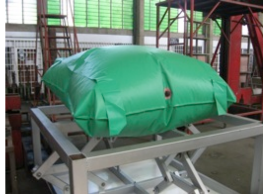
Figura 8 Mecanismo para mantener la horizontalidad del marco.
