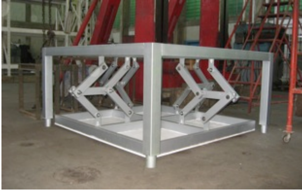
Figura 8 Mecanismo para mantener la horizontalidad del marco.
