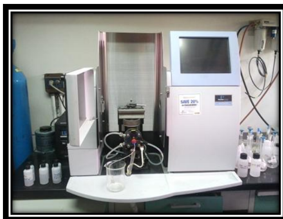
Figura 22. Equipo de Absorción atómica. Tomada por Andreina Fernández.
