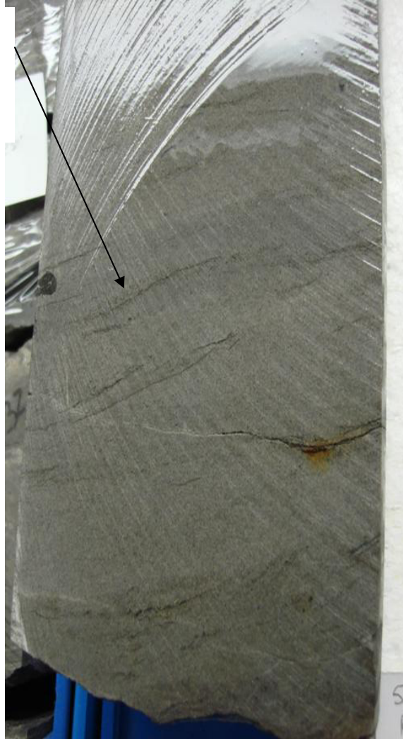
Figura 49. Detalle de las Laminaciones de Rizaduras en el núcleo.
