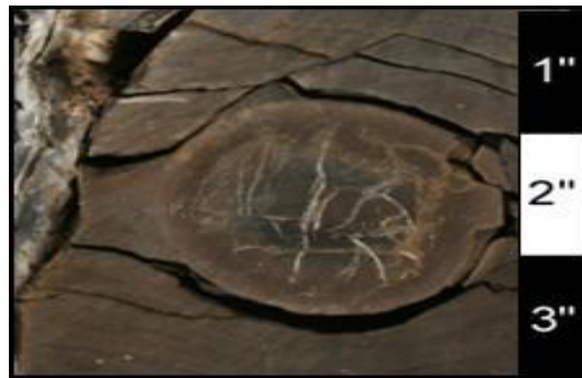
Figura 53. Facies LU1. Fotografía del núcleo AGV-423, a la profundidad de 11389'. Se muestra una importante concreción siderítica en este estrato.
