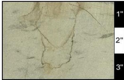
Figura 32. Facies AFM. Fotografía del núcleo AN-007, a la profundidad de 16110'. Se aprecia un color beige claro, con pequeñas "manchas" negras.
