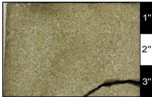
Figura 45. Facies AGM. Fotografía del núcleo AN-007, a la profundidad de 16080,5'. Se observa la estratificación masiva.
