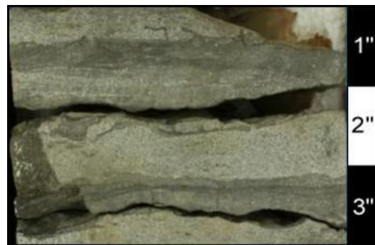
Figura 56. Facies LU1. Fotografía del núcleo AN-007, a la profundidad de 16050'. Se observa claramente el bandeamiento de colores.
