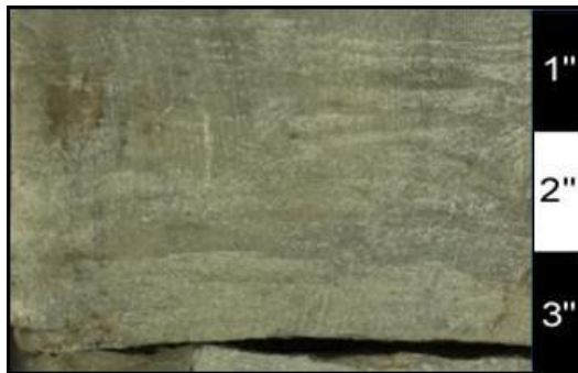
Figura 28. Facies AMFE. Fotografía del núcleo AN-007, a la profundidad de 16095'. Nótese la presencia de laminaciones flaser.
