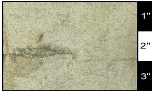
Figura 38. Facies AFM. Fotografía del núcleo AN-007, a la profundidad de 15742'. Se aprecia una bioturbación horizontal y la presencia de "manchas" negras dentro del estrato de color claro.
