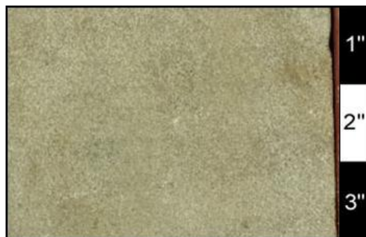
Figura 43. Facies AME. Fotografía del núcleo AN-007, a la profundidad de 16058'. Se aprecia un buen escogimiento dentro del estrato.
