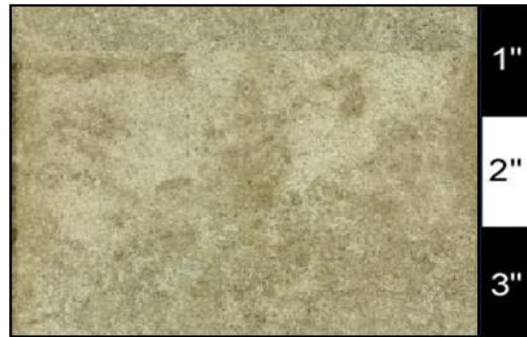
Figura 35. Facies AFM. Fotografía del núcleo AN-007, a la profundidad de 15755'. Estrato altamente bioturbado; con Chondrites , Planolites (Ichnofacies cruziana) y otros sin diferenciar.
