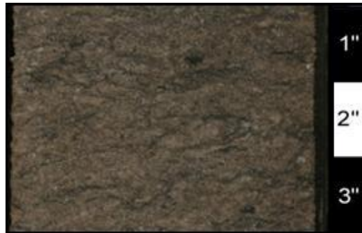
Figura 33. Facies AFM. Fotografía del núcleo AGV-423, a la profundidad de 13386'. Se aprecia el color marrón rojizo oscuro con "manchas" negras.
