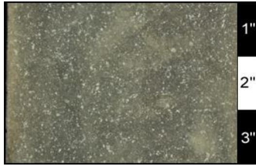
Figura 34. Facies AFM. Fotografía del núcleo AN-007, a la profundidad de 15977'. En esta, se aprecian granos gruesos subangulares de color blanco, dentro del estrato.
