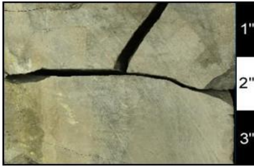
Figura 31. Facies AFM. Fotografía del núcleo AN-007, a la profundidad de 16107'. Se aprecia el color gris claro, moteado con marrón claro y las "manchas" negras.
