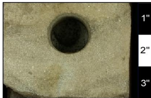
Figura 47. Facies AGE. Fotografía del núcleo AGV-423, a la profundidad de 13276'. Obsérvese la laminación flaser dentro del estrato.
