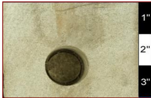
Figura 29. Facies AMFE. Fotografía del núcleo AN-007, a la profundidad de 15764'. Se aprecian bioturbaciones verticales sin diferenciar.
