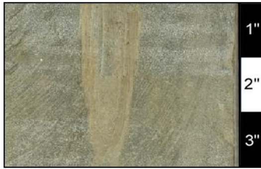
Figura 27. Facies AMF. Fotografía del núcleo AN-007, a la profundidad de 15999'. Nótese la importante bioturbación vertical.
