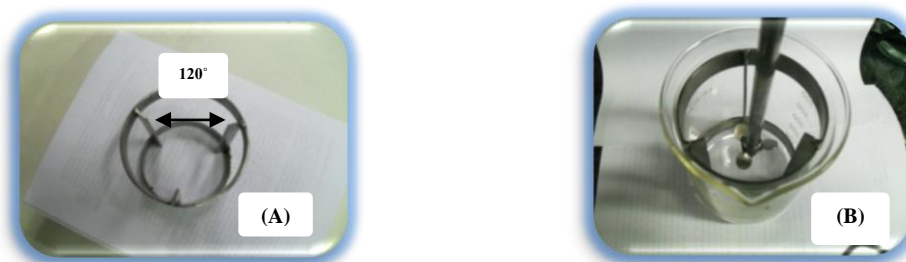
Figura 29. Imagen del deflector diseñado, superior (A) y dentro del recipiente de agitación (B).
