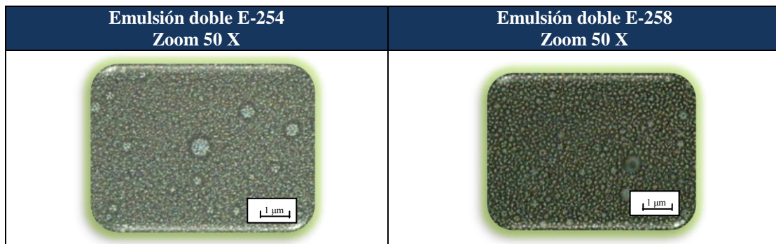
Figura 33. Imagen en el microscopio de las emulsiones dobles E-254 y E-258 con un zoom de 50X.
