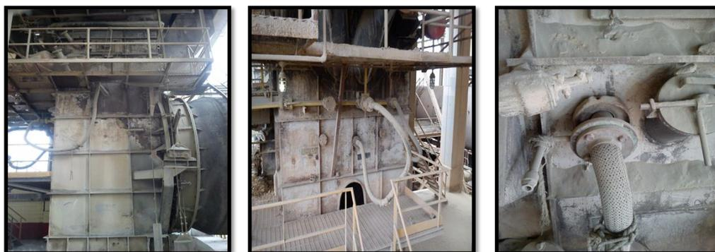
**Figura N°43** Unión de la rampa con el horno (izquierda), quemador inferior (Central), quemador superior (derecha)
