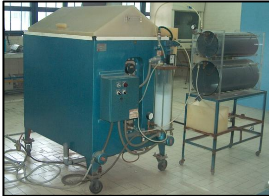
Figura 7. Cámara de niebla salina (Escuela de Ingeniería Metalúrgica UCV, 2005).
