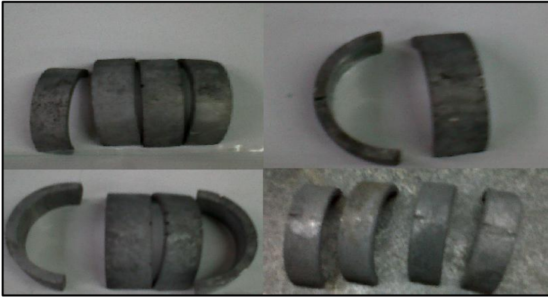
Figura 31. Cupones metálicos decapados luego de efectuar ensayos corrosivos.
