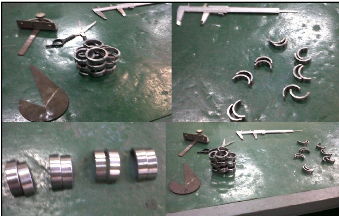
Figura 30. Piezas metálicas utilizadas en los ensayos de corrosión.
