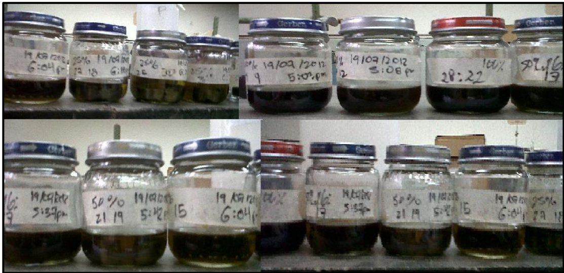
Figura 33. Impregnación de las muestras por inmersión.
