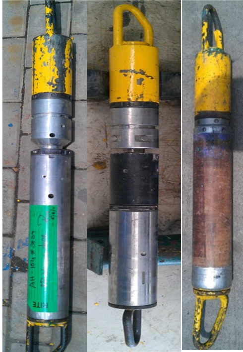
Fig. II.9: Adaptadores (tomado del Top Operator Manual de SLB)
