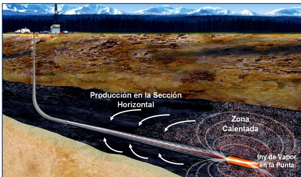
Figura 9. Configuración de un pozo SW-SAGD. Fuente PDVSA
