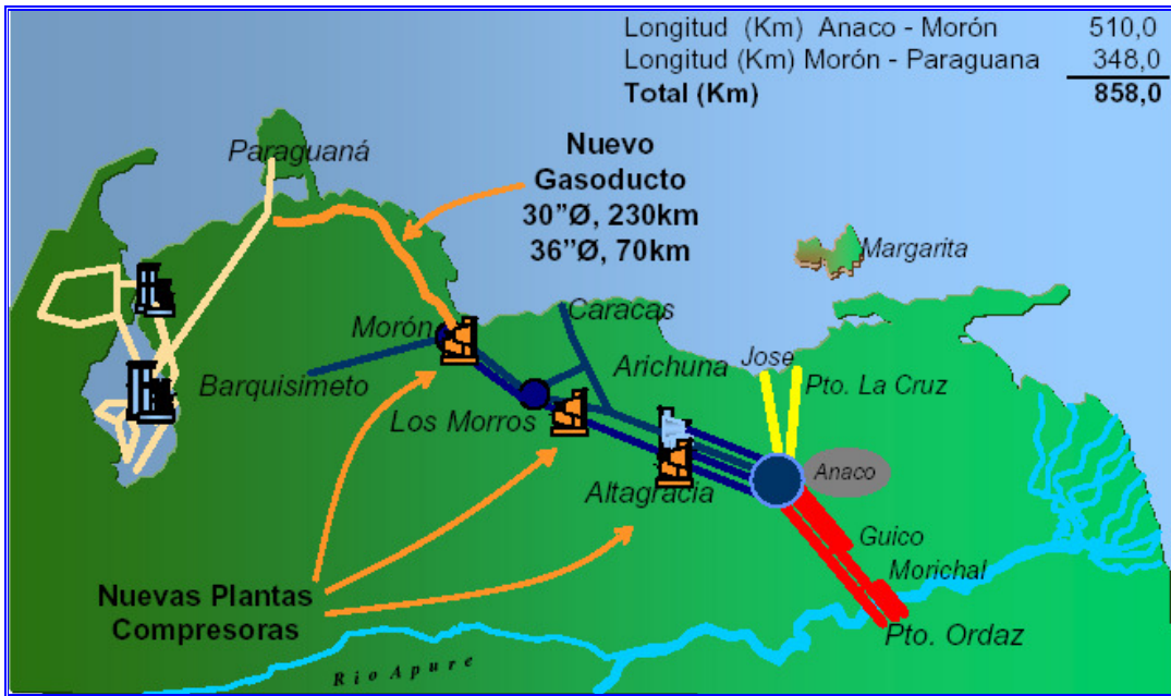
Figura 2: Infraestructura del proyecto ICO
