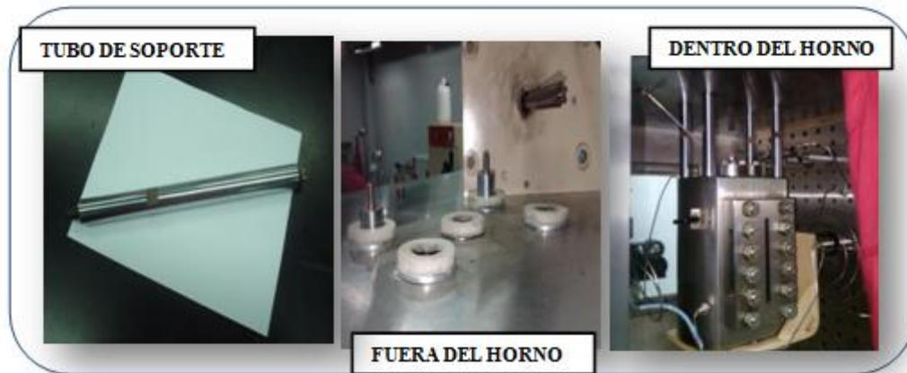
**Figura 6.11** Soportes de fijación para la celda.
