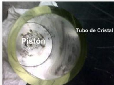
**Figura 5.4** Tubo o Cilindro de cristal con el pistón.
