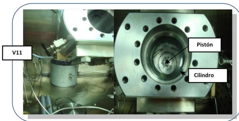
**Figura 6.7** Colocación del cilindro de vidrio con el pistón dentro de la celda.
