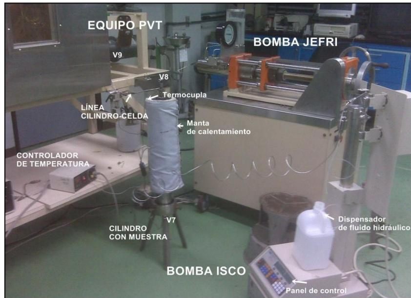
Figura 6.18 Montaje experimental para la inyección de la muestra de crudo a la celda.
