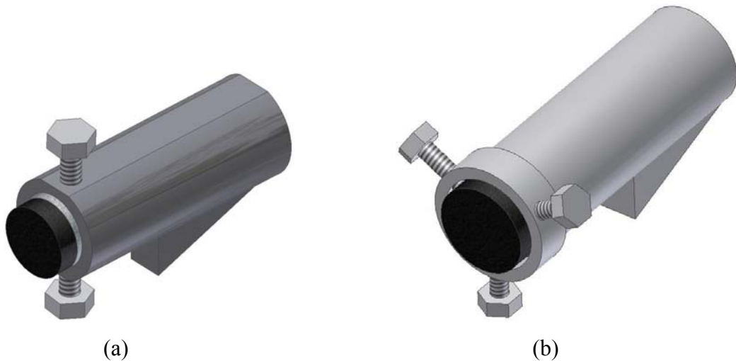
Figura 3.15.: Diseño de porta probetas realizados en un paquete de diseño por computadora. (a) Porta probeta de PDC/WC-Co. (b) Porta probeta de Acero H13 - DLC.
