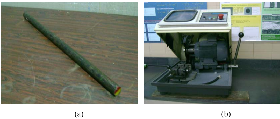
Figura 3.3.: Proceso de corte de Muestras de 1 in de diámetro y 10 mm. de espesor. (a) Barra adquirida en la Empresa FERRUM C.A., (b) Maquina de Corte por Disco Abrasivo.
