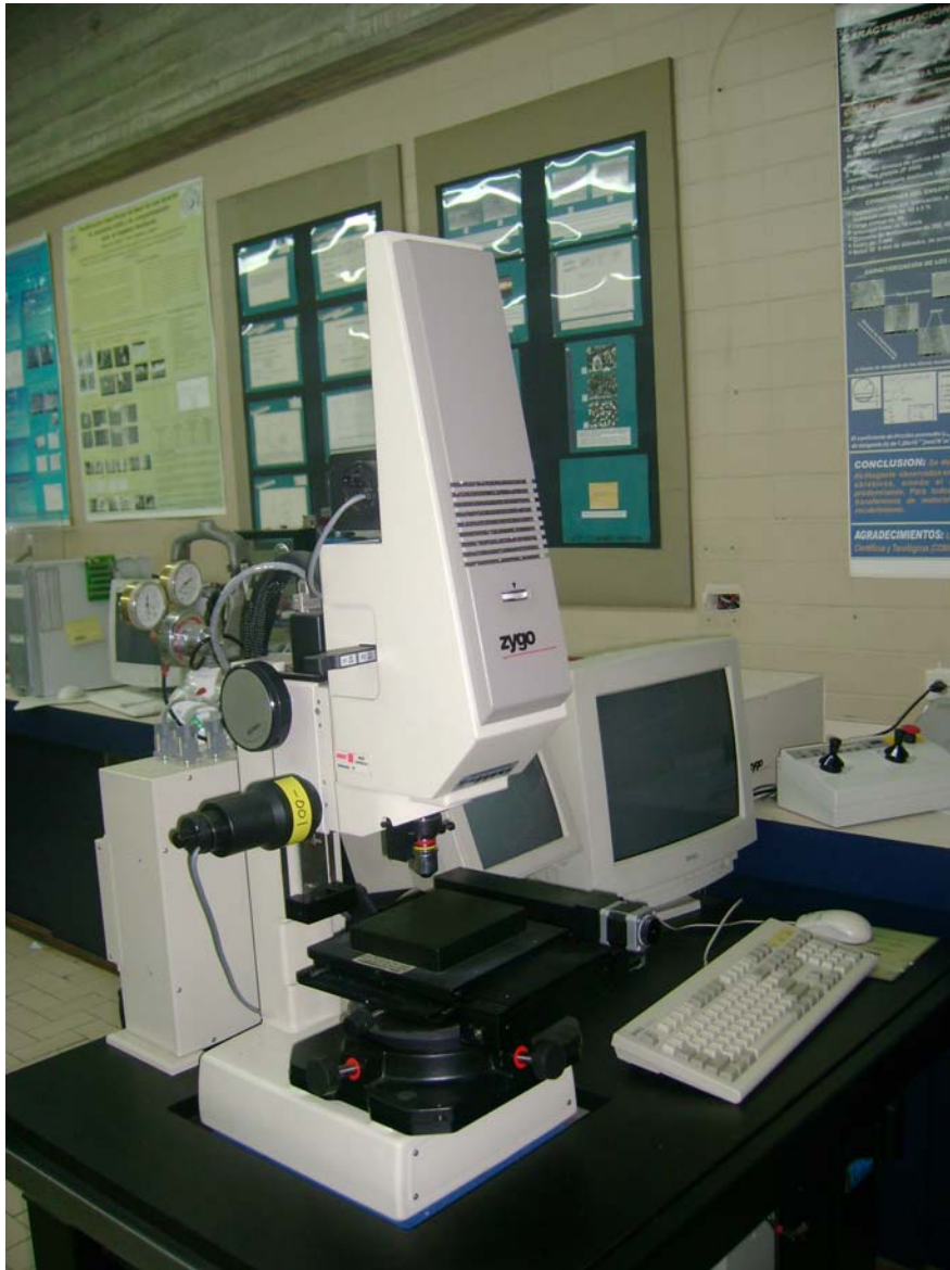
Figura 3.14.: Perfilometro marca ZYGO, ubicado en el Laboratorio Nuevos Materiales de la Escuela de Ingeniería Metalúrgica de la Universidad Central de Venezuela.
