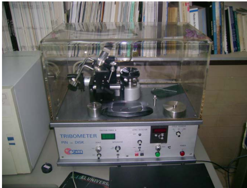
Figura 3.13.: Tribómetro marca CSEM Tribometer Pin-On-Disk, ubicado en el Laboratorio Nuevos Materiales de la Escuela de Ingeniería Metalúrgica de la Universidad Central de Venezuela.
