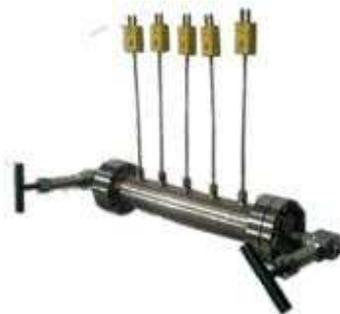
Figura 4. 2. Celda de desplazamiento de la unidad de inyección alterna de vapor
