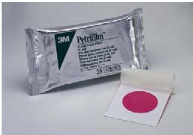
**Figura 20: Placas petrifilm para recuento de coliformes totales y *E.coli* utilizadas durante la investigación**
