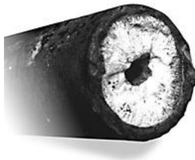
Figura 1.2. Reducción del área efectiva
