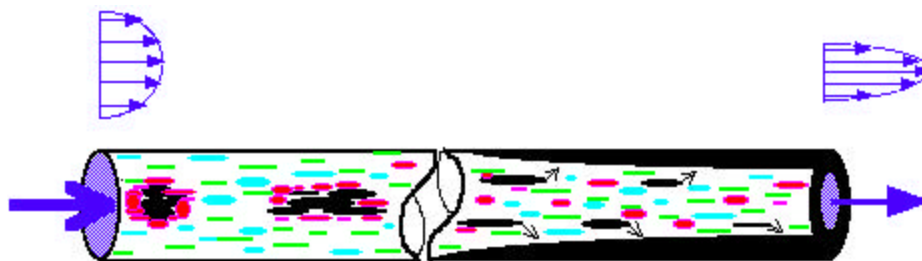
Figura 1.1. Deposición de parafina
