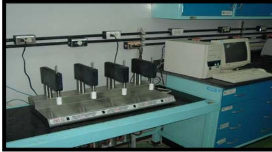
Figura 23: Medidor de hinchamiento lineal.
