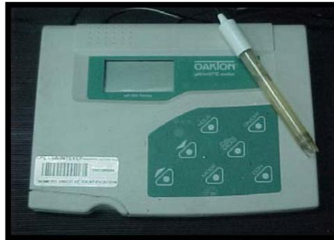
**Figura 15:** Medidor electrónico de pH.
