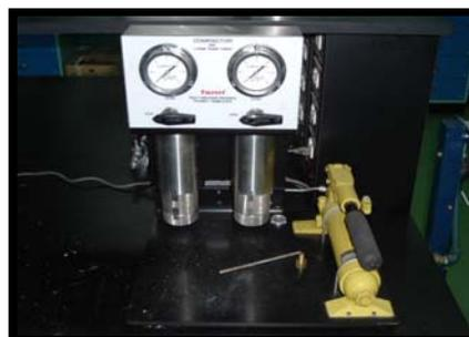
Figura 27: Compactador para hacer núcleos de lutitas.
