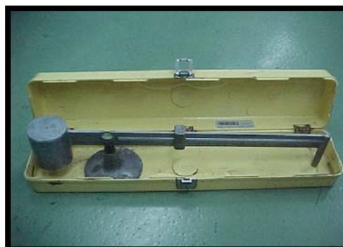
Figura 14: Balanza de lodo.
