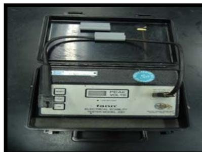
Figura 24: Medidor de estabilidad eléctrica.
