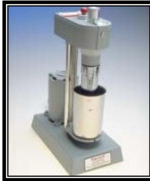
**Figura 21:** Viscosímetro rotacional Fann® 35A.
