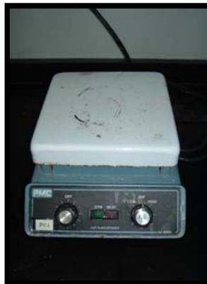
Figura 28: Agitador magnético.
