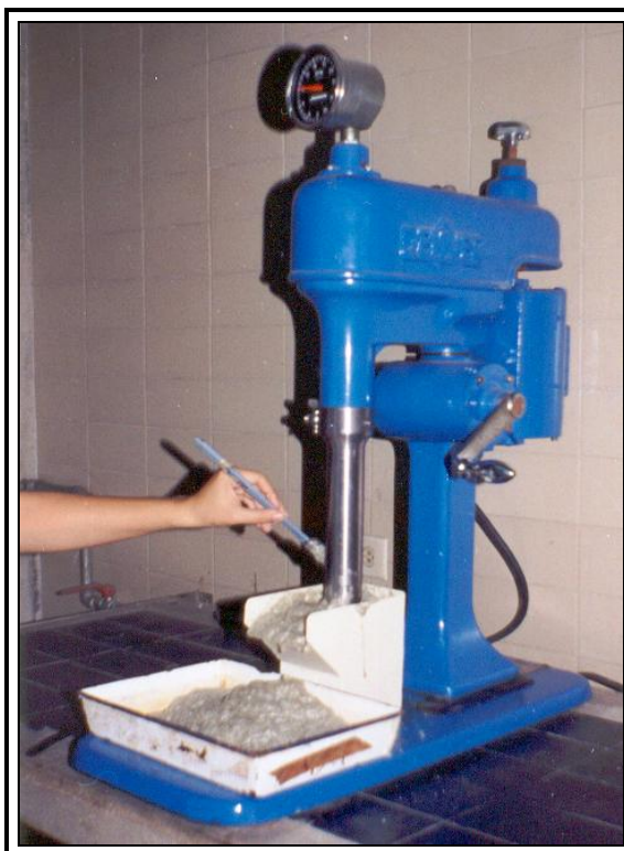
Fig. 20. Máquina de Flotación para Pruebas de Laboratorio Marca Denver, D-12 Flot. Laboratorio de Docimasia, Departamento de Minas, U.C.V.
