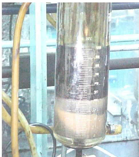
*Figura 25 : Fases separadas usando una mezcla de surfactante A / surfactante C : 900/1350 ppm*
