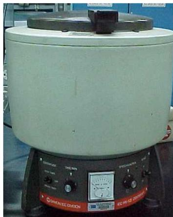
*Figura 19: Centrifuga para probetas de 12.5 ml*
