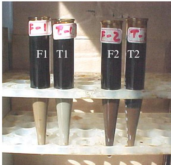
*Figura 44: Botellas con la emulsión obtenida al someter al fluido al hidrociclón*
