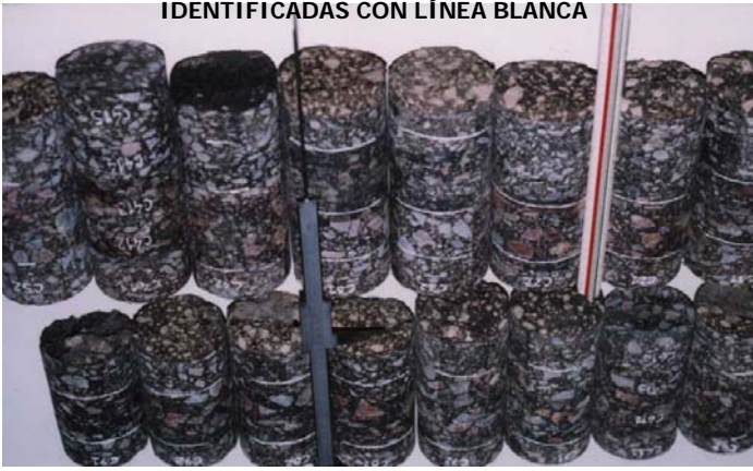
TESTIGOS COMPLETOS CON CARPETAS ASFÁLTICAS IDENTIFICADAS CON LÍNEA BLANCA
