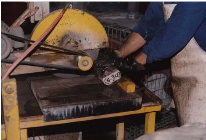
CORTE CON SIERRA PARA SEPARACIÓN DE CARPETAS ASFÁLTICAS
