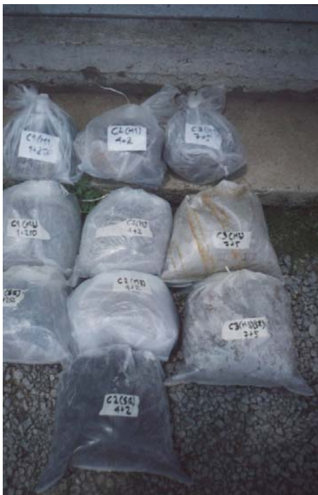
MUESTRAS PROCEDENTES DE LAS DIFERENTES CAPAS DE LAS CALICATAS
