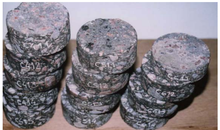
TESTIGOS DIVIDIDOS EN LAS DIFERENTES CARPETAS ASFÁLTICAS QUE LOS COMPONEN
