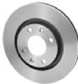
Figura 3.12: Disco sólido hecho de acero 1020. Fuente: http://www.discodefreno.net
