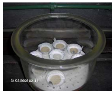
Figura 29. Fotos de ensayo de los sólidos totales y suspendidos de las muestras de agua colectadas.
