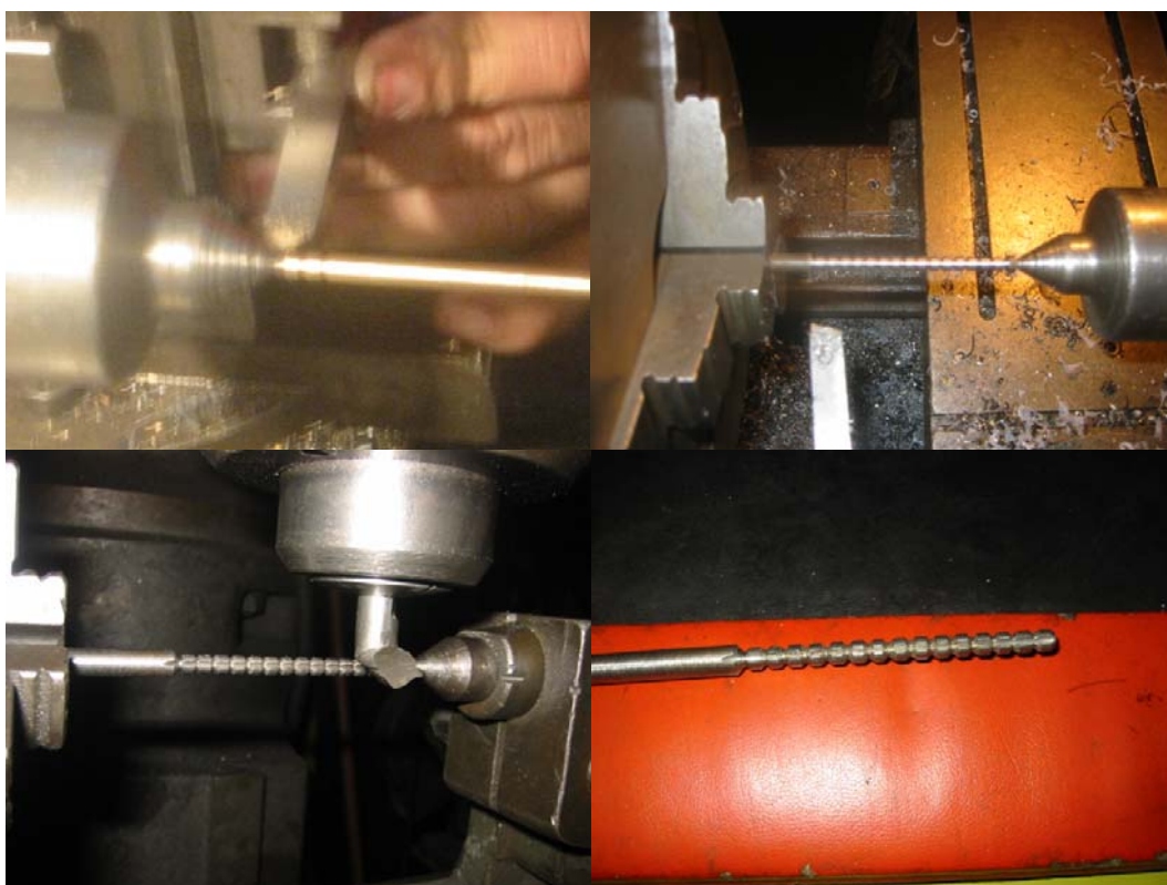
Figura 96. Proceso de fabricación de la matriz del clavo
