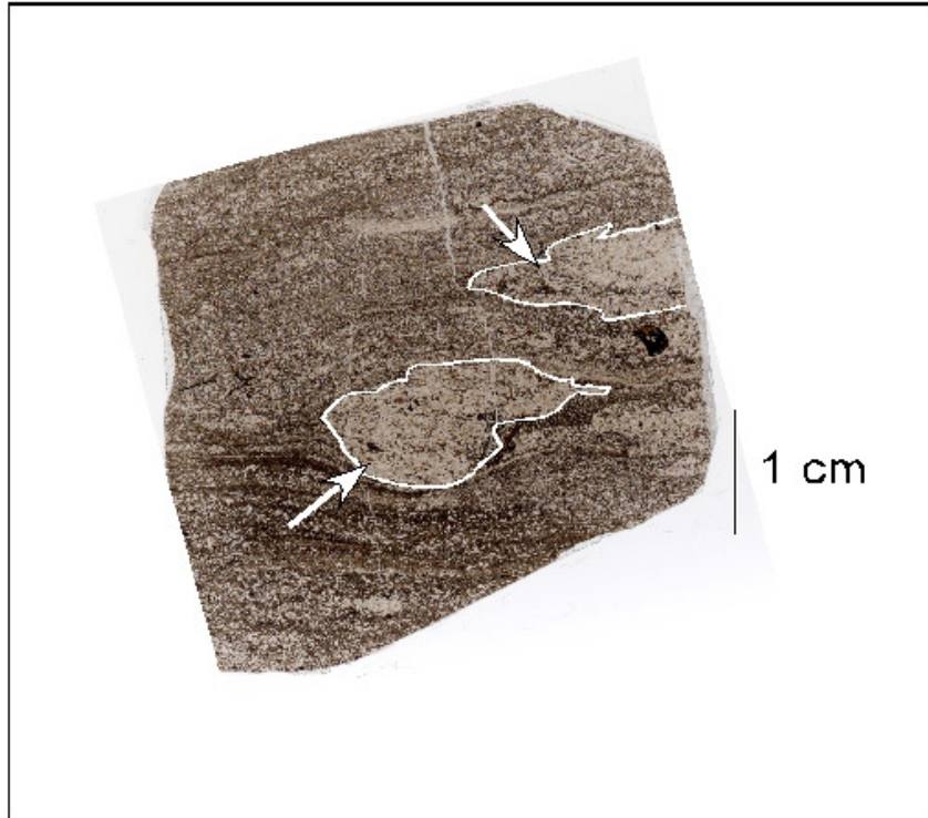
Fig. 12 Fotografía de una caliza margosa (a 19,52 m), en donde se observan horadaciones señalizadas con una línea blanca, representadas por secciones más o menos circulares rellenas principalmente por foraminíferos bénticos.
