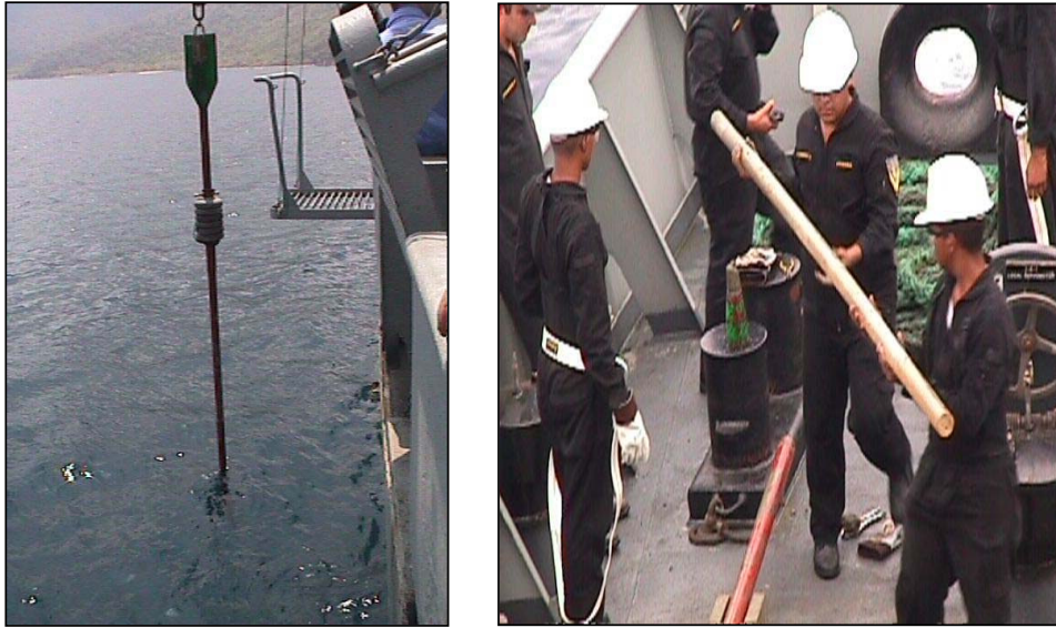
Figura 5.2.- Fotografías del nucleador de gravedad empleado para la toma de los núcleos de fondo marino. A la derecha se observa un núcleo recolectado.
