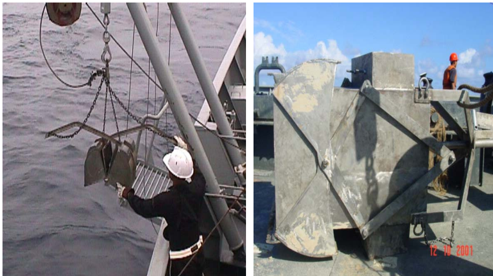
Figura 5.3.- Fotografías de la draga mecánica empleada para la toma de muestras de sedimentos marinos superficiales.
