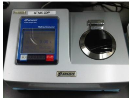
Figura N°10. Refractómetro Atago utilizado para medir °Bx de las muestras (Elaboración propia)
