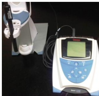
Figura N°6. Medidor de oxígeno disuelto Orion 3 DO Benchtop (Elaboración Propia)
