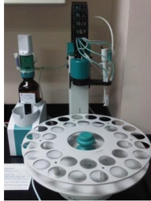
Figura N°8. Tituladora automática Metrohm utilizada para medir la acidez cítrica de las muestras (Elaboración propia)
