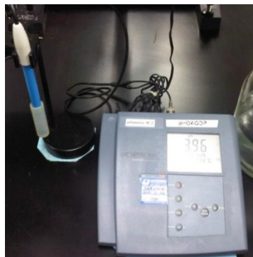
Figura N°7. pHmetro utilizado para la medición del pH de las muestras (Elaboración propia)
