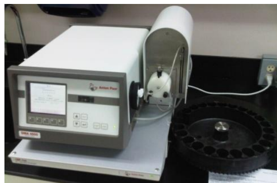
Figura N°9. Densitómetro Anton Paar DMA 4500 utilizado para la medición de la densidad de las muestras (Elaboración propia)
