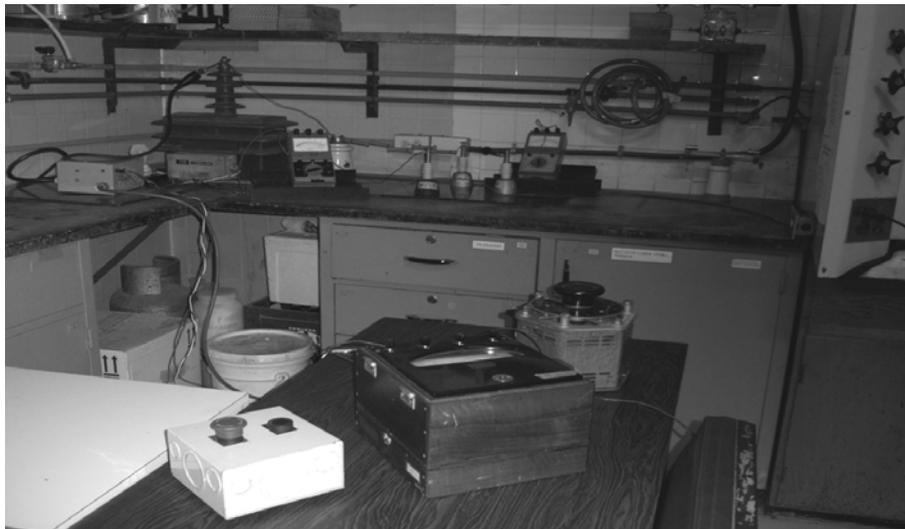
Figura N° 16. Circuito de corriente alterna de alto voltaje. (Elaboración propia)
