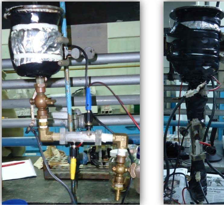
Figura N° 14. Izquierda: Orientación horizontal, sin aislamiento en tubería, Derecha: Orientación vertical, con aislamiento en tubería
