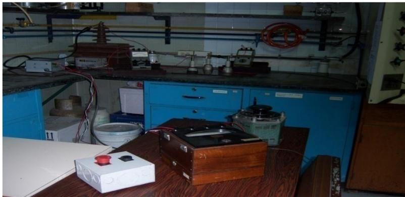
**Figura 17.-** Montaje para la aplicación de campo eléctrico (Pérez, 2012)
