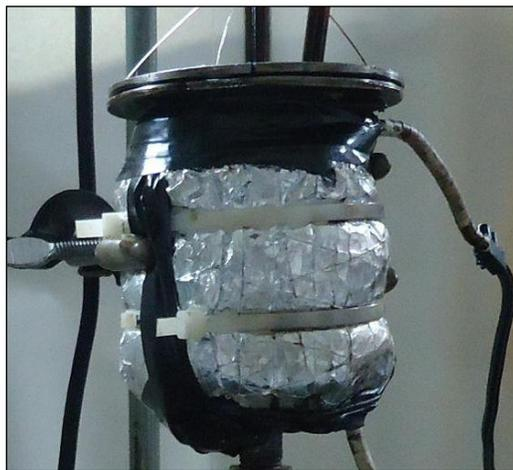
**Figura 26.-** Tanque de calentamiento con aislamiento de fibra de vidrio.
