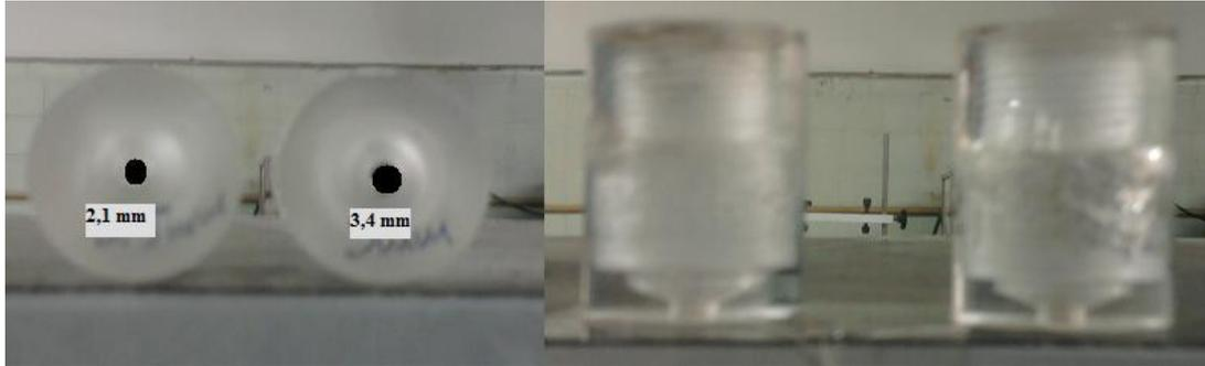
**Figura 23.** Piezas que representan las aperturas de la Válvula V-2. (LSM)
