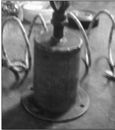
**Figura 19.** Tanque de calentamiento con resistencia.
