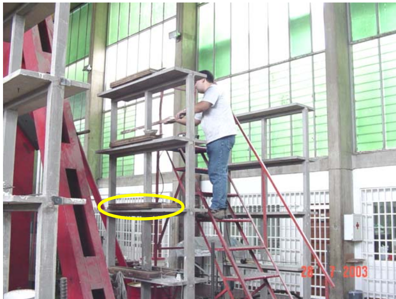
Fig. #4-8. Colocación de masas adicionales a la estructura.
