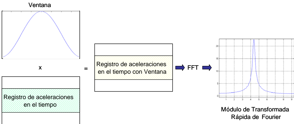
Fig. #5-11. Efecto de la aplicación de las ventanas en el registro de aceleraciones en el tiempo.
