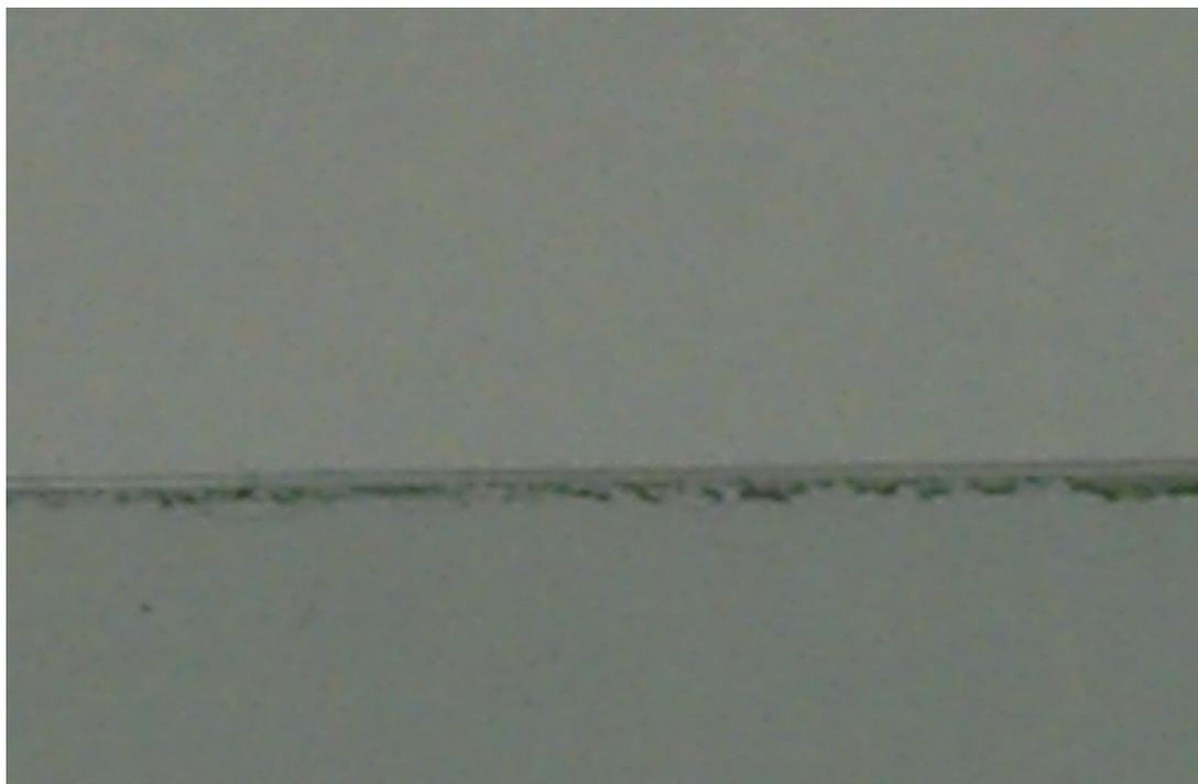
En la foto de corte regular observamos que todavía existe en ciertas partes del corte desconche del vidrio, la superficie presenta en algunas partes irregularidad y en otras no, a pesar de esto todavía se pierde medianamente material al realizar los acabados finales.
