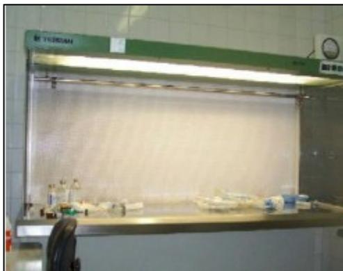
**Figura 1.** Cabina de Flujo Laminar. **Fuente:** Internet (2009)
