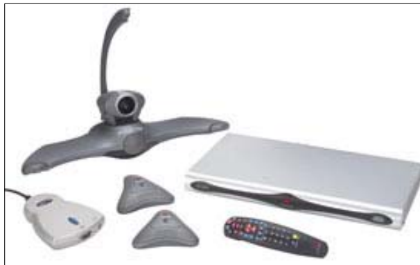
Figura 3.2. Equipo de videoconferencia Polycom VSX 8400. [Extraído de www.polycom.com ]
