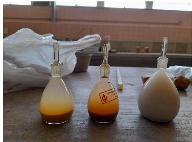
Picnómetros antes y después de vacío. A la derecha antes, a la izquierda: después
