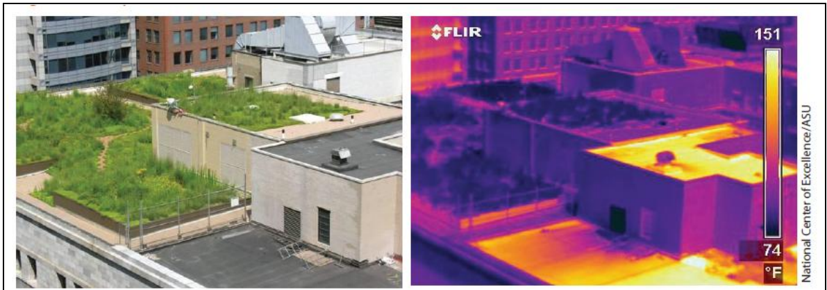
Figura 52. Chicago. Diferencias de temperatura superficial entre techo Verde semi-intensivo y techo convencional sobre edificio del ayuntamiento
