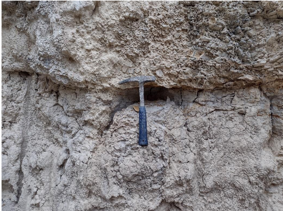
Figura 4.3 Se observa dos materiales cuyo contacto es discordante, siendo el material en el tope fragmentos angulares de esquistos sericíticos en una matriz y en la parte inferior una capa de arcilla.
