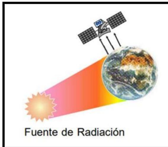
**Figura 2.6** Sensor pasivo de un satélite (Tomado de Bravo, 2017).
