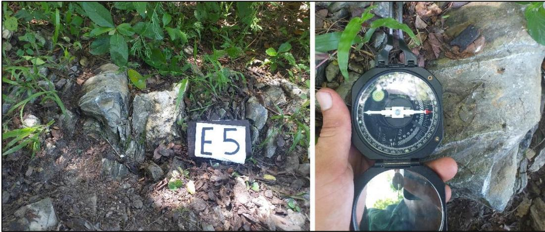
**Figura 5.45** Plegamiento anticlinal orientado N75E.
