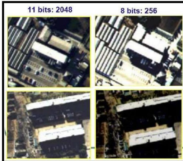
**Figura 2.10** Resolución radiométrica – Comparación entre dos sensores con diferentes resoluciones radiométricas (Arenas, 2016).
