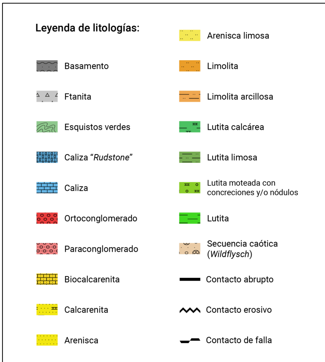
Fig. 52: Leyenda para las litologías, empleadas a lo largo de todas las secciones sedimentarias esquemáticas.
