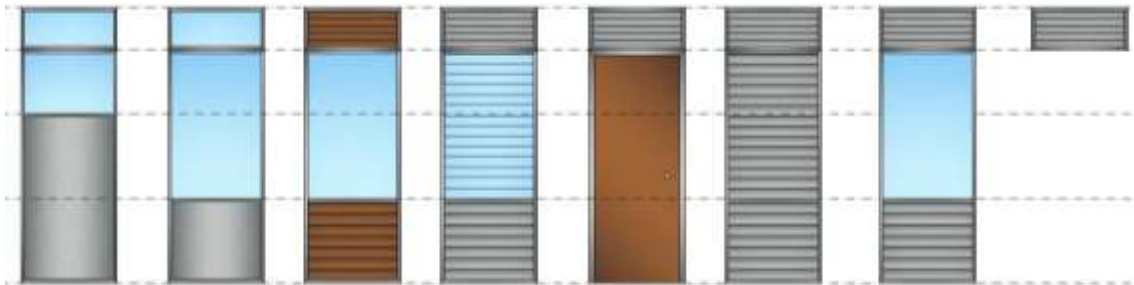
Fig. 53: Combinación de paneles de ventanas y puertas
