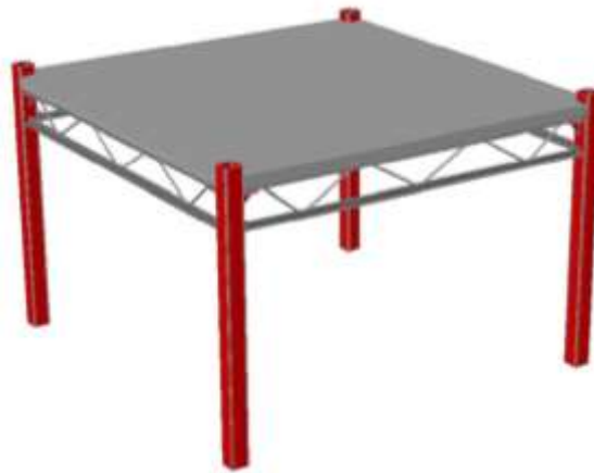
Fig. 8: Columnas, vigas y losa
