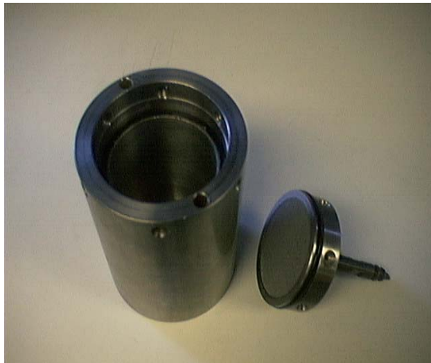
Figura III.6 Celda contenedora de lodo para equipo AT - AP Tester de Estabilidad Eléctrica
