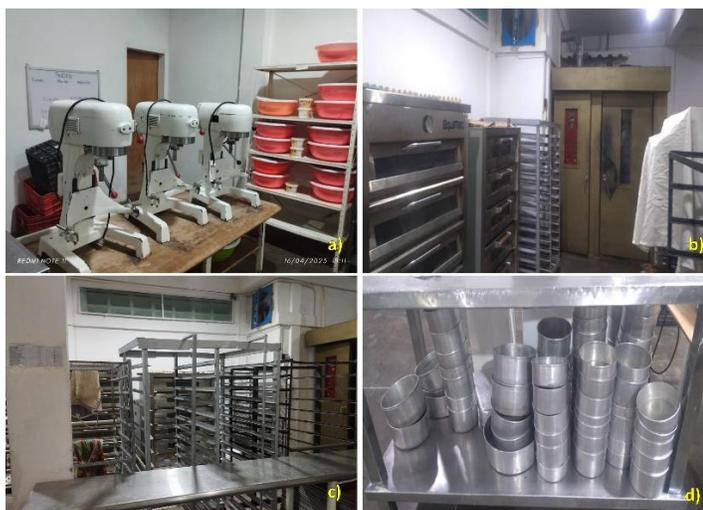
**Figura 4.** Maquinarias disponibles en el Departamento de Producción de Torta Inversiones Yaqui C.A.®. a) Batidoras; b) Hornos; c) Carritos; d) Moldes y utensilios en general.
